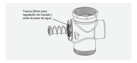
Caudal máximo es 10 L por accionamiento. Recomendamos regular la válvula a 6 L de agua por accionamiento para cuidar de este recurso ambiental.
